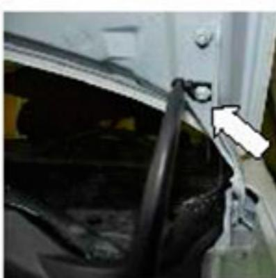
3. Открутить нижнюю гайку крепления капота. Установить кронштейн капота, уперев его в ребро жесткости. Затянуть гайку моментом 23 Нм.
