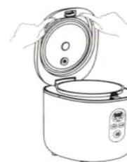
2. Используя две выемки на внутренних сторонах крышки, извлеките алюминиевую крышку;
