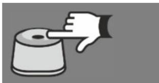
2. При выключенном зажигании нажмите **служебную кнопку** 4 раза. Каждое нажатие кнопки сопровождается свечением светодиодного индикатора.
