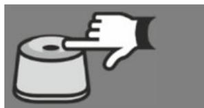
1. При выключенном зажигании нажмите **служебную кнопку** 6 раз. Каждое нажатие кнопки сопровождается свечением светодиодного индикатора.
