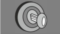
2. Сядьте в автомобиль и включите зажигание (ключ в положение IGNITION, но не START!)
