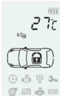
Брелок подаст мелодичный сигнал, на дисплее будет отображено состояние сигнализации, текущий режим и открытые зоны, а также значение температуры в салоне автомобиля.
