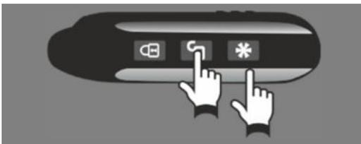
Для остановки двигателя, запущенного брелком или автоматически, нажмите последовательно **кнопки 2 и 3** брелка (нажатие кнопки 2 - длительное, до звукового сигнала, нажатие кнопки 3 - короткое).
