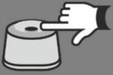
3. Для навигации по таблице функций нажимайте **служебную кнопку**. По количеству и длительности сигналов сирены и вспышек светодиодного индикатора можно контролировать номер программируемой функции:
