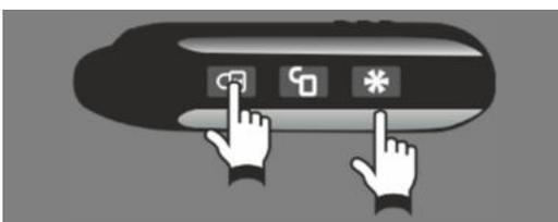
Во время запуска двигателя, для продления времени его работы нажмите последовательно **кнопки 1 и 3** брелка (нажатие кнопки 1 - длительное, до звукового сигнала, I нажатие кнопки 3 - короткое).
