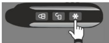
Выход из "**карусельного меню**" происходит при удержании **кнопки 3** в течение 3 секунд, а также при отсутствии действий пользователя в течение 7 секунд.
