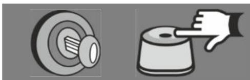
При выключенном режиме охраны и закрытых дверях: включите зажигание, нажмите и удерживайте **служебную кнопку** в течение 4 сек.
