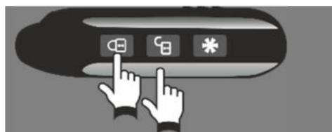
Нажмите последовательно **кнопки 1 и 2** брелка (нажатие кнопки 1 - длительное, до звукового сигнала, нажатие кнопки 2 - короткое).
