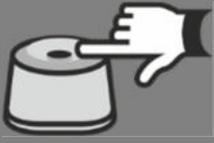
1. При выключенном зажигании нажмите **служебную кнопку** 5 раз. Каждое нажатие кнопки сопровождается свечением светодиодного индикатора.
