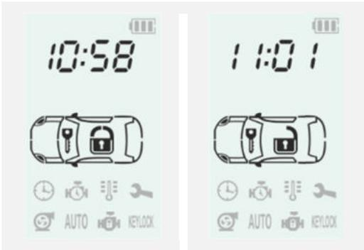
Кроме того, сигнализация может автоматически запереть и отпереть замки дверей в одном из 4 режимов {определяется программируемой функцией №1.2):
