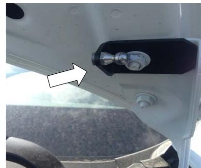
3. Открутить верхнюю гайку крепления капота. Установить кронштейн капота, уперев его в ребро жесткости. Затянуть гайку ключом №12 с усилием 23 Нм.
