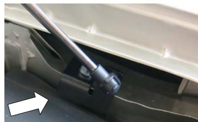
2. Установить кронштейн крыла, как показано на рисунке. Плотнo прижать подгиб кронштейна к кузову и затянуть болт и гайку ключом №13 с усилием 23 Нм.
