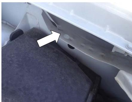
1. Кронштейн крыла устанавливается в технологическое отверстие, показанное на рисунке.
