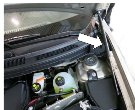
4. Прокатать амортизатор (упереть в твердую поверхность, несколько раз полностью сжать и отпустить).
