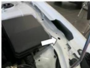
1. Завести под отверстие в кузове гайку закладную M8x50.
