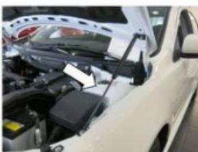
2. Установить кронштейн крыла, закрепив его к кузову болтом M8x30 с шайбой 8. Плотно прижать подгиб кронштейна к кузову и затянуть болт ключом №13 с усилием 23 Нм.
