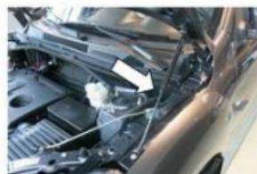
4. Прокачать амортизатор (упереть в твердую поверхность, несколько раз полностью сжать и отпустить).
