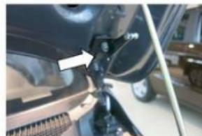
3. Открутить верхний болт крепления капота. Установить кронштейн капота, уперев его в ребро жесткости. Затянуть болт моментом 23 Нм.
