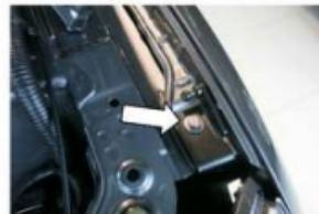
2. Установить кронштейн крыла, как показано на рисунке. Плотно прижать подгиб кронштейна к кузову и затянуть болт ключом №10 с усилием 9 Нм.
